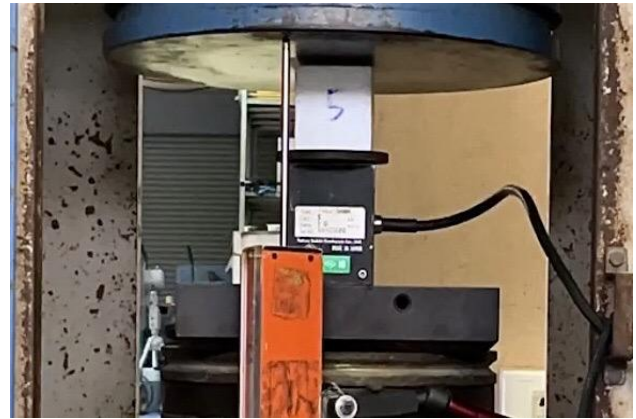
รูปที่ 6 การทดสอบโฟม EPS ภายใต้แรงอัด
