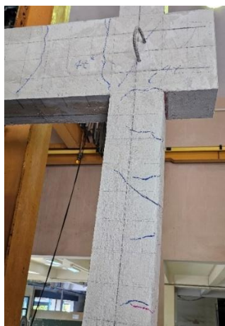
รูปที่ 15 รอยร้าวที่ปรากฏเพิ่มขึ้นในโครงข้อแข็งที่ไม่มีวัสดุก่ออิฐมวลเบาเมื่อแรงกระทำเพิ่มขึ้น
