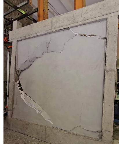
รูปที่ 19 การแตกร้าวในโครงข้อแข็งที่มีวัสดุก่อ EPS
