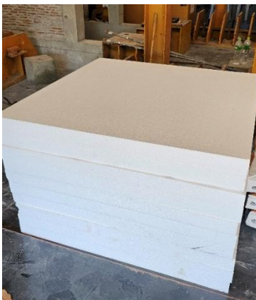
รูปที่ 5 โฟมที่ใช้ในโครงข้อแข็งคอนกรีตเสริมเหล็กที่มีวัสดุก่อโฟม EPS
