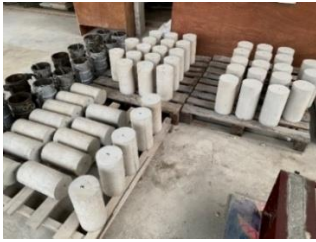
รูปที่ 4 ก้อนตัวอย่างที่ออกแบบกำลังอัดที่ 100, 200 และ 300 ksc
