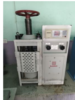
รูปที่ 7 เครื่องทดสอบ Compressive Strength machine 200 T
