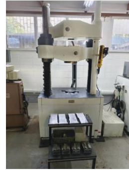
รูปที่ 6 เครื่องทดสอบ Universal Testing Machine (UTM) 100 T
