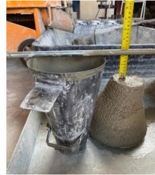
รูปที่ 2 การตรวจเช็ค Slump
