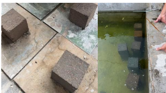
รูปที่ 6 ตัวอย่างก้อนคอนกรีตผสมเศษไม้เทียมบ่มในน้ำ
