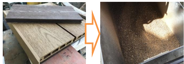
รูปที่ 2 บดย่อยเศษไม้เทียมก่อนผสมพลาสติก
