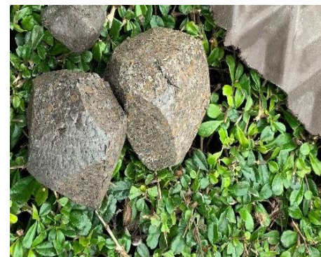
รูปที่ 4 หลอมเศษไม้เทียมบดย่อยกับขยะพลาสติกพีพีด้วยความร้อน
