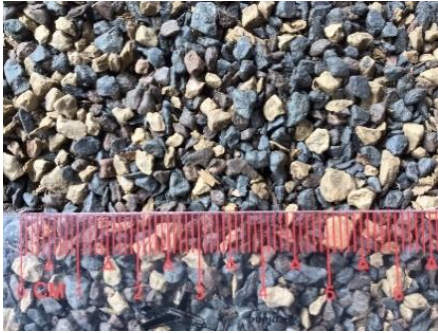
รูปที่ 5 หินเทียมจากการบดย่อยเศษไม้เทียมผสมกับพลาสติกพีที
