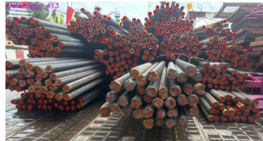
รูปที่ 5 ตัวอย่างการตรวจนับเหล็กเสริมจากภาพถ่ายด้านหน้า
