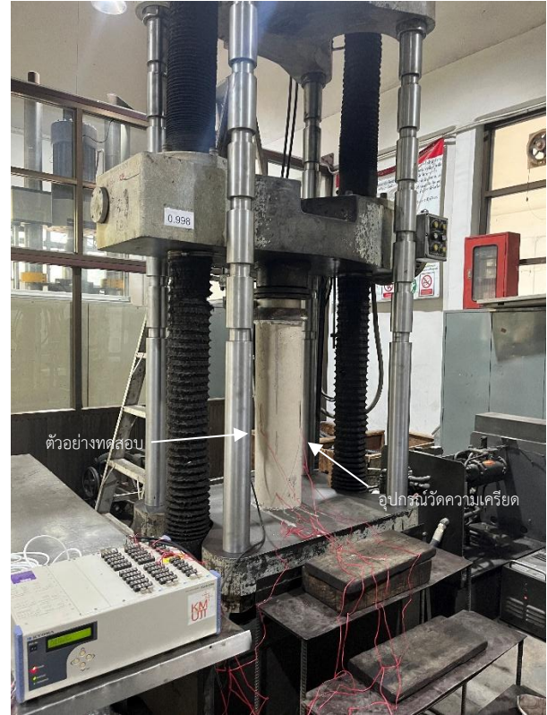
รูปที่ 6 การติดตั้งตัวอย่างทดสอบในเครื่องทดสอบการรับแรงอัดตามแนวนอน
