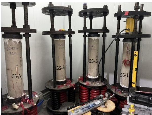
รูปที่ 8 การติดตั้งตัวอย่างทดสอบในเครื่องทดสอบการคืบอัดตามแนวแกน
