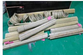
รูปที่ 1 แท่งพอลิเมอร์เสริมใยแก้ว (Glass Fiber Reinforced Polymer, GFRP)
