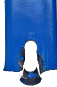
รูปที่ 17 การวิบัติจากการทดสอบในห้องปฏิบัติการจากแรงดึงแบบสถิต
