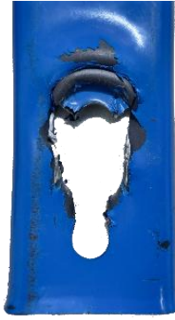
รูปที่ 20 การวิบัติจากการทดสอบในห้องปฏิบัติการจากแรงอัดแบบสถิต
