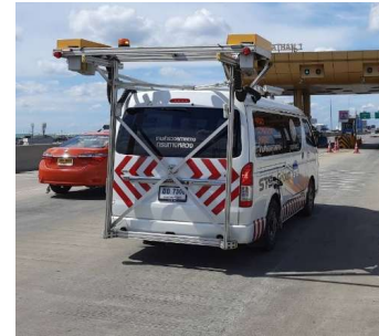
รูปที่ 2 รถตู้สำรวจติดตั้ง Laser Profiler
