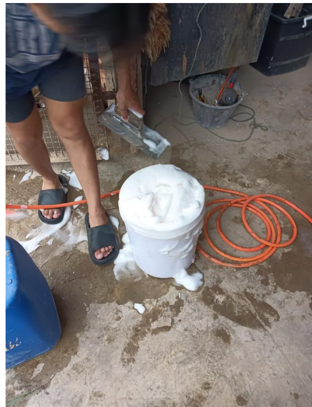
รูปที่ 3 การทดสอบความหนาแน่นโฟมเหลว
