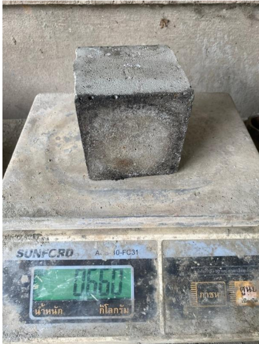
รูปที่ 4 การทดสอบหน่วยน้ำหนักของคอนกรีตมวลเบาเซลลูโลส
