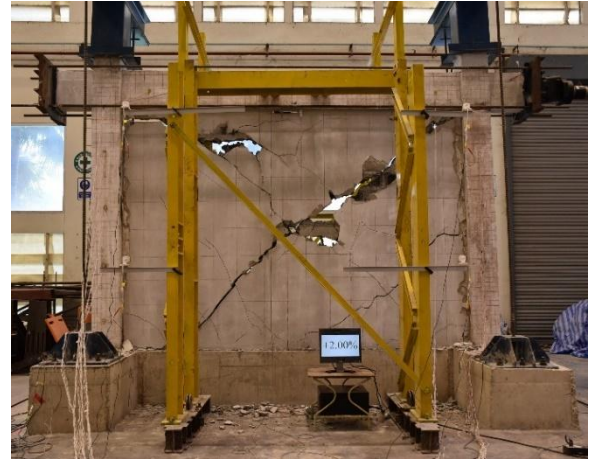
รูปที่ 4 ความเสียหายในผนังอิฐก่อของตัวอย่างทดสอบที่การเคลื่อนตัวด้านข้างสัมพัทธ์ 2.00 %
