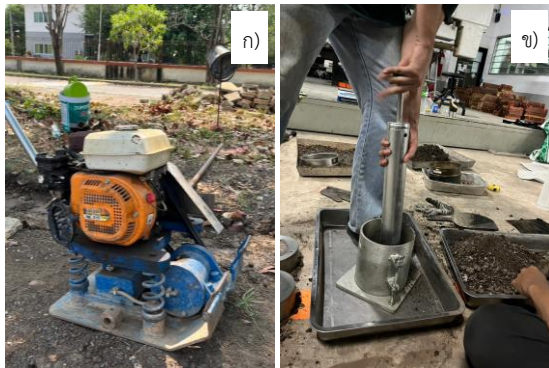
รูปที่ 4 อุปกรณ์การบดอัดดิน ก) เครื่องตบหน้าดินผิวเรียบขนาดเล็กทำงานด้วยมือแบบสันสะเทือน และ ข) การบดอัดดินแบบพลศาสตร์ในห้องปฏิบัติการ
