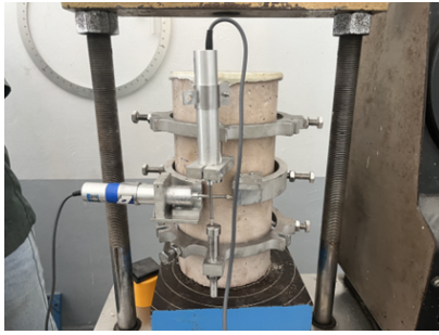
รูปที่ 1 การทดสอบหาค่ากำลังรับแรงอัดและโมดูลัสของความยืดหยุ่น
