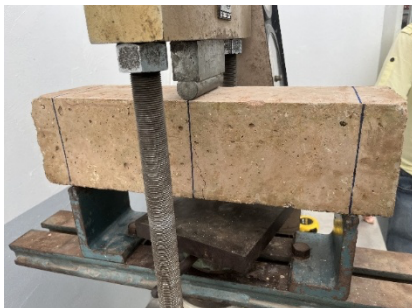
รูปที่ 2 การทดสอบการดัดของพลาสติกคอนกรีต (Flexural strength of Plastic Concrete)
