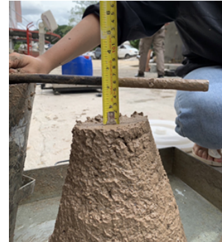
รูปที่ 4 การทดสอบการสูญเสียค่าการยุบตัว (Slump loss)
