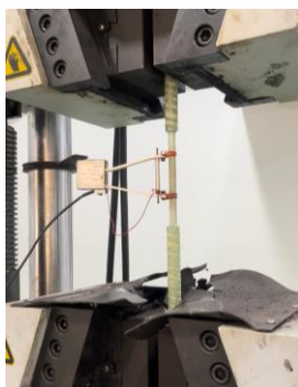
รูปที่ 2 การทดสอบรับแรงดึงด้วยเครื่องทดสอบอเนกประสงค์
