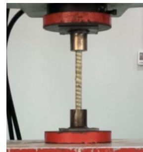
รูปที่ 3 การทดสอบรับแรงอัดด้วยเครื่องทดสอบอเนกประสงค์
