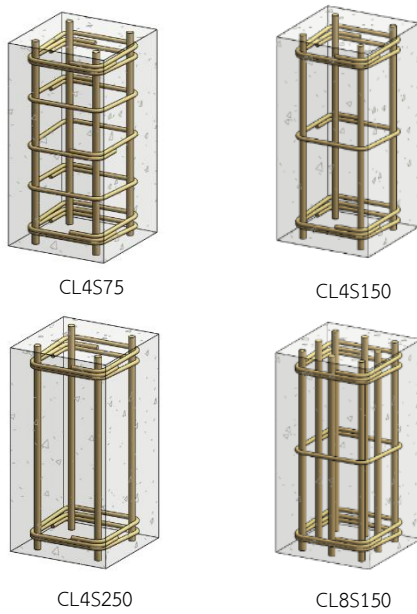
รูปที่ 4 รายละเอียดการเสริมเหล็กเส้น GFRP
