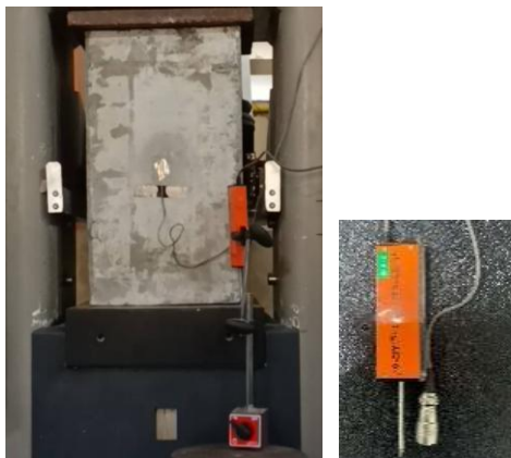
รูปที่ 5 การทดสอบรับแรงอัดของเสาคอนกรีตเสริมเหล็กเส้น GFRP
