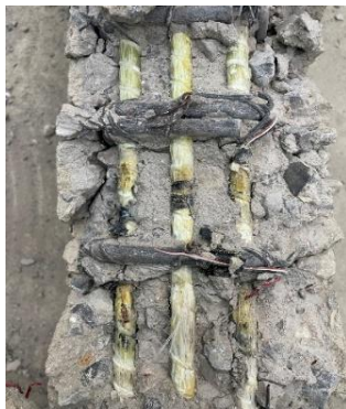
รูปที่ 8 ลักษณะเหล็กเสริมพอลิเมอร์เส้นใยแก้วที่อุณหภูมิ 150 องศาเซลเซียส
