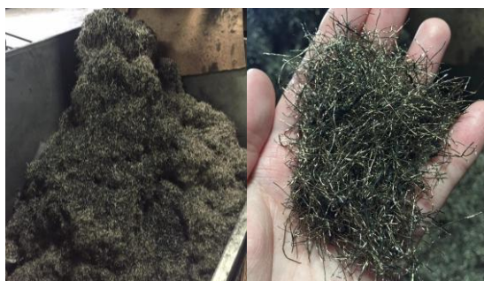
รูปที่ 1 เส้นใยเหล็กเหลือทิ้งจากยางรถยนต์ (Steel waste fiber)
