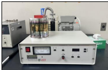
ภาพที่ 9 นำตัวอย่างคอนกรีตเคลือบผงทองคำ
