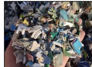
ภาพที่ 4 ขยะพลาสติกที่นำมาใช้แทนวัสดุมวลรวมละเอียด
