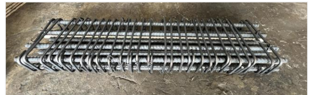
รูปที่ 10 ชิ้นงานตัวอย่างทดสอบคานอย่างง่ายที่มีพฤติกรรมเสมือนคานสะพานระบบขึ้นส่วนคานรูปกล่องสำเร็จรูป (ด้านข้าง)
