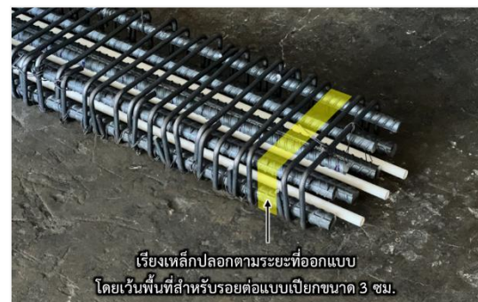
รูปที่ 10 ชิ้นงานตัวอย่างทดสอบคานอย่างง่ายที่มีพฤติกรรมเสมือนคานสะพานระบบขึ้นส่วนคานรูปกล่องสำเร็จรูป (ด้านข้าง)
