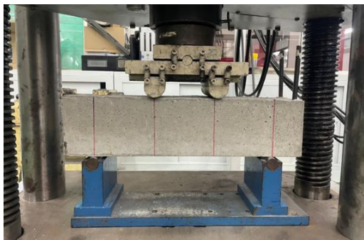
รูปที่ 3 การตัดคานแบบให้น้ำหนักกดสี่จุด (Four-point loading) เพื่อสร้างรอยร้าว
