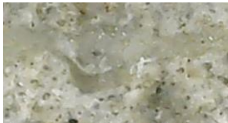
รูปที่ 6 ลักษณะการซ่อมรอยร้าวของแบคทีเรีย LMG 22257
