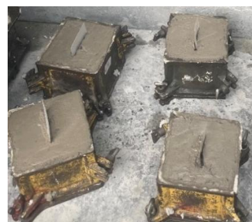
รูปที่ 2 ลักษณะการเสียบแผ่นพลาสติกเพื่อสร้างรอยร้าว
