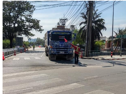
(จ) การทดสอบกำลังรับน้ำหนักสะพานแบบสถิตย์
