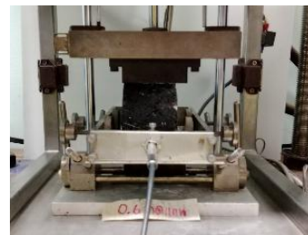
รูปที่ 9 การทดสอบโมดูลัสการคืนตัวเนื่องจากแรงดึงทางอ้อม
