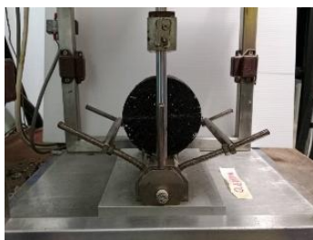
รูปที่ 8 การทดสอบกำลังดึงทางอ้อม (Indirect Tensile Strength)
