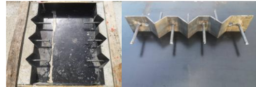
รูปที่ 11 Multiple Shear Key สลักเสริมแผ่นเหล็กหนา 2 มม. และเสริม Dowel ช่องเว้นช่อง สลักรูปสามเหลี่ยม (หน่วยเป็นมิลลิเมตร)
