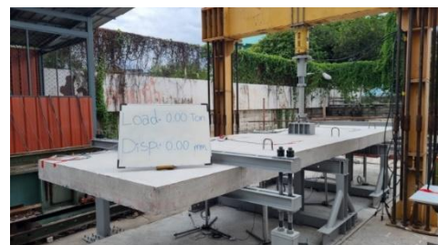
รูปที่ 7 การทดสอบกำลังรับแรงสูงสุดของพื้นสะพาน
