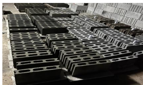
รูปที่ 5 บ่มคอนกรีตบล็อกในอากาศ
