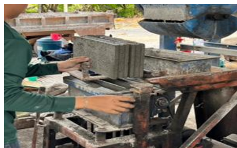
รูปที่ 4 การขึ้นรูปคอนกรีตบล็อก
