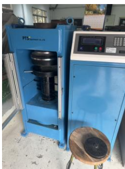
รูปที่ 2 เครื่องทดสอบกำลังอัดของคอนกรีต
