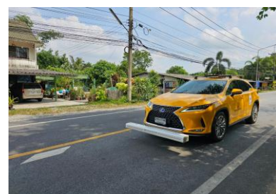
รูปที่ 14 การทดสอบ IRI ด้วย Hawkeye 1000
