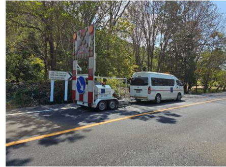
รูปที่ 12 การทดสอบ Stiffness ด้วย FWD
