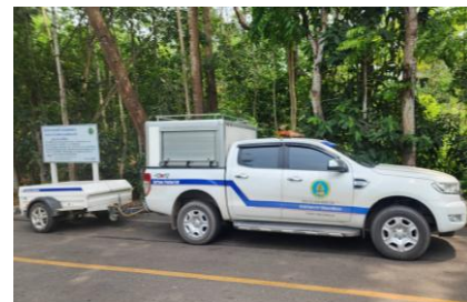
รูปที่ 13 การทดสอบ \mu ด้วย SFT T-10
