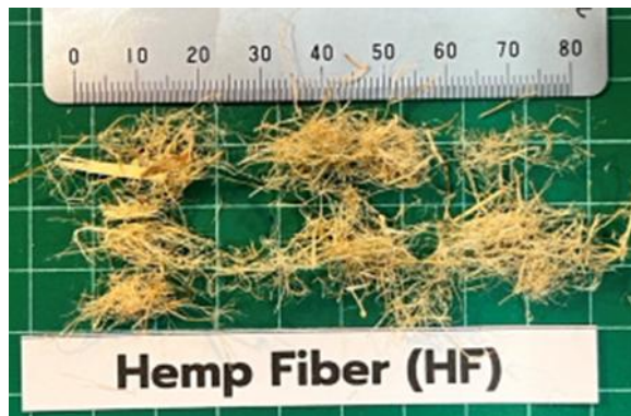
รูปที่ 2 ตัดและคัดแยกเส้นใยของให้ได้ความยาวเฉลี่ย 20 มม.
