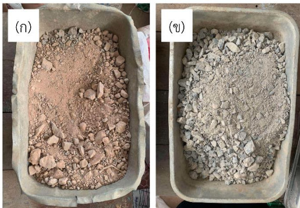
รูปที่ 1 วัสดุที่ใช้ทดสอบ (ก) ดินลูกรัง และ (ข) หินคลุก
