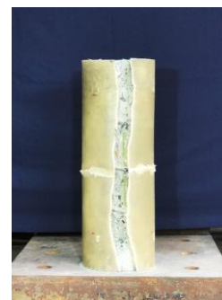
รูปที่ 15 ลักษณะการวิบัติของท่อพอลิเมอร์เสริมเส้นใยแก้ว
