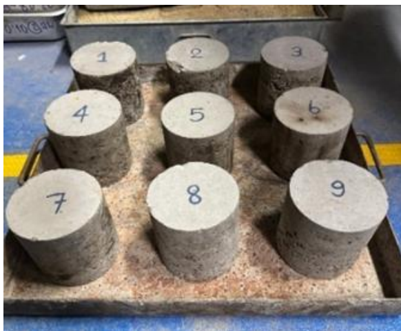
รูปที่ 6 นำตัวอย่างออกจากตู้อบวางพักที่อุณหภูมิปกติ
