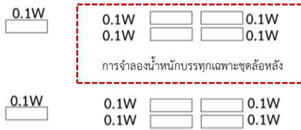
รูปที่ 5 การกระจายน้ำหนักจราจรลงแต่ละล้อ
