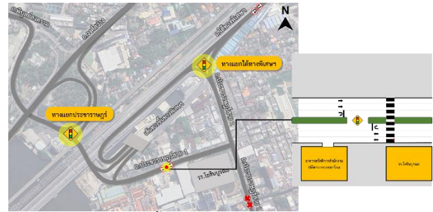
รูปที่ 5 กรณีที่ 3 ติดตั้งสัญญาณไฟจราจรบริเวณจุดกลับรถหน้าอาคาร สวัสดิการสำนักงานปลัด
