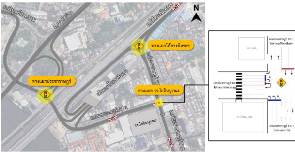
รูปที่ 3 กรณีที่ 1 ติดตั้งสัญญาณไฟจราจรบริเวณสามแยก โรงเรียนโยธินบูรณะ
