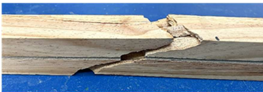
(ง) การวิบัติจากแรงดึงแบบประชิด (BT)
