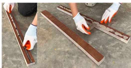
(ข) ตัดเทปกาวยาว และติดตั้งวัสดุเสริมกำลัง
