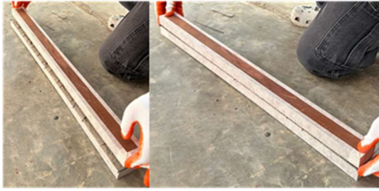
(ค) ประกอบไม้ตัวอย่างและบ่มอีพอกซีไว้ที่อุณหภูมิห้อง
