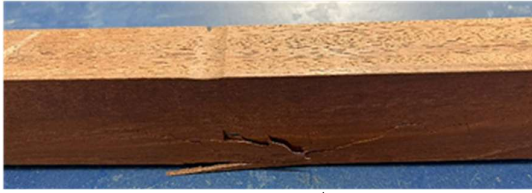
(ก) การวิบัติจากแรงดึงทั่วไป (ST)
