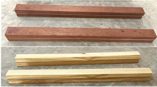
(ง) หลังจากครบกำหนดการบ่ม นำเหล็กรอกออก และทำการตรวจสอบความเรียบร้อยของรอยต่อ ก่อนเข้าสู่กระบวนการทดสอบแรงดัด
