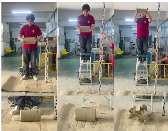
รูปที่ 12 การทดลองปล่อยตกอย่างอิสระของตัวอย่างดินซีเมนต์ที่ใช้ปริมาณซีเมนต์ 20% ที่ระยะยก 100 เซนติเมตร, 190 เซนติเมตร และ 250 เซนติเมตร
