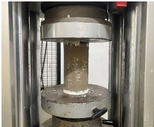
รูปที่ 3 การทดสอบหากล้างรับแรงอัดแบบแกนเดียวของก้อนตัวอย่างดินซีเมนต์
