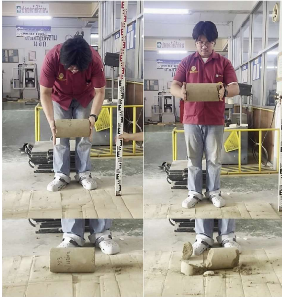
รูปที่ 11 การทดลองปล่อยตกอย่างอิสระของก้อนตัวอย่างดินซีเมนต์ที่ใช้ปริมาณซีเมนต์ 15% ที่ระยะยก 50 เซนติเมตร และ 100 เซนติเมตร
