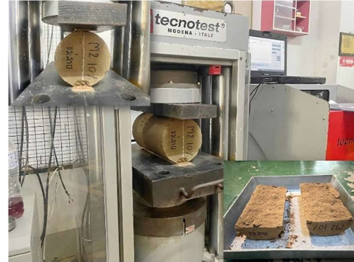
รูปที่ 4 การทดสอบแรงดึงแบบผ่าซีก (Splitting Tensile Strength Test)
