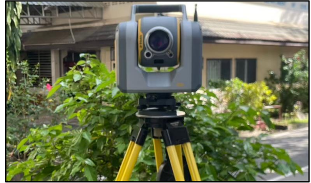
รูปที่ 2 เครื่อง Trimble SX10 Scanning Total Station
