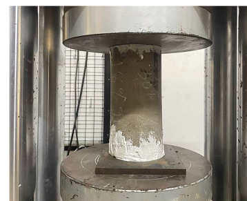
(ข) การทดสอบแรงอัดแกนเดียวของตัวอย่างดินซีเมนต์
