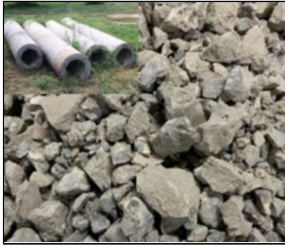
รูปที่ 2 คอนกรีตรีไซเคิลที่มาจากเสาเข็มที่ไม่ใช้แล้ว [14]
