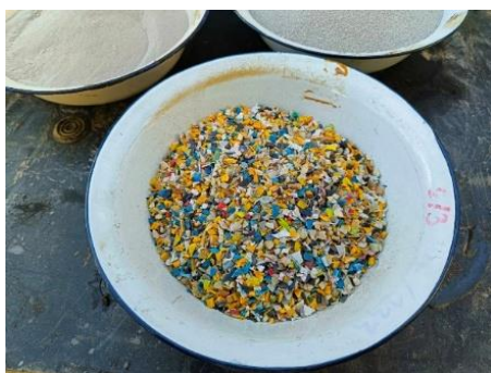
รูปที่ 4 ขยะพลาสติกที่ใช้แทนที่วัสดุมวลรวมละเอียดในส่วนผสมคอนกรีต
