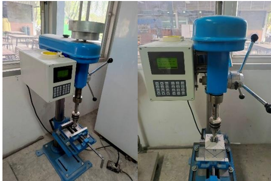
รูปที่ 5 เครื่องทดสอบความต้านทานการสึกกร่อนคอนกรีต (ASTM C944-99)
