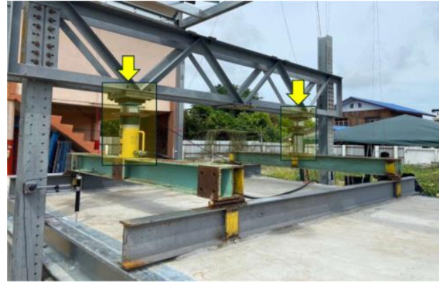
รูปที่ 7 การทดสอบความสามารถในการรับน้ำหนัก (Gravity Load-Carrying)
