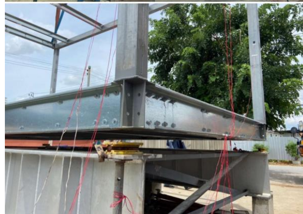
รูปที่ 9 การทดสอบเสถียรภาพโครงสร้างขณะยกย้าย (Lifting Test)
