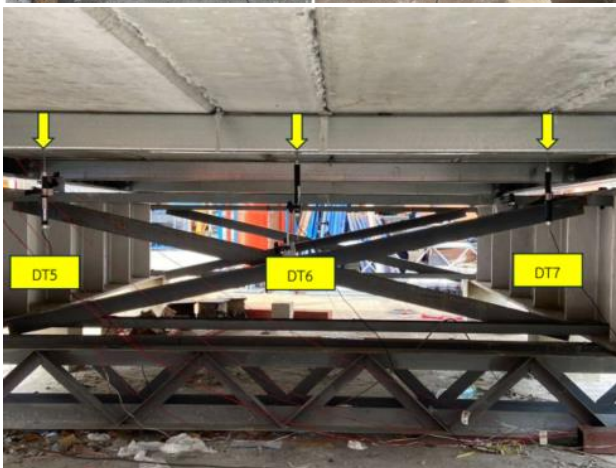
รูปที่ 6 การติดตั้งเครื่องมือวัดการเคลื่อนตัว (Displacement Transducers)
