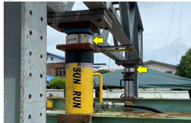
รูปที่ 7 การทดสอบความสามารถในการรับน้ำหนัก (Gravity Load-Carrying)
