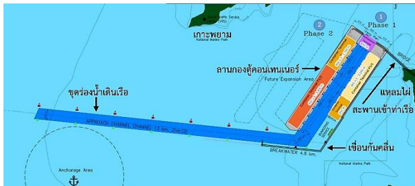
รูปที่ 2 รูปแบบของโครงสร้างท่าเรือ
