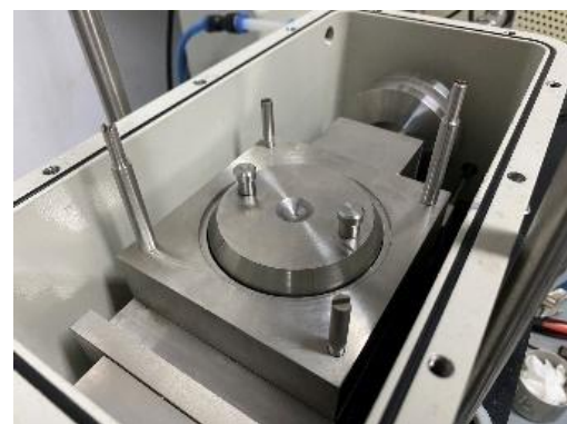
รูปที่ 2 Unsaturated Shear Box ใน Sealed Sample Chamber
