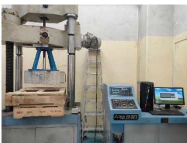
รูปที่ 6 การทดสอบกำลังยึดหน่วงของเหล็กเสริมที่ฝังในเสาคอนกรีต
