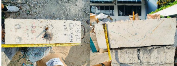
รูปที่ 14 การวัดแบบขาดจากแรงดึง (เหล็กเสริมขาด)
