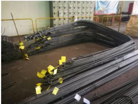
รูปที่ 5 เหล็กตัด-ดัดสำเร็จรูปจากโรงงาน (Cut and Bend : CAB) [2]
