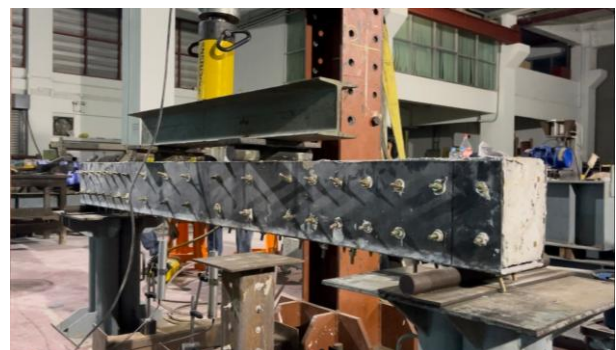
รูปที่ 4 รูปแบบการให้น้ำหนักบรรทุกกระทำบนคานตัวอย่างที่ใช้ทดสอบ
