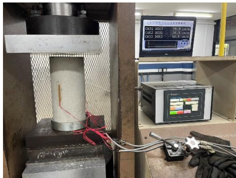
รูปที่ 5 การทดสอบกำลังรับแรงอัดของคอนกรีตผสมเม็ดยางที่มีปริมาณคอนกรีตไม่เท่ากัน และอัตราส่วนของเม็ดยางแทนที่มวลรวมละเอียดที่ 20% 25% 30% และ 40% ที่อายุ 7 และ 28 วัน
