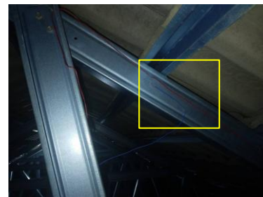
รูปที่ 8 ตัวอย่างตำแหน่งการติดตั้ง Thermal gauge บนชิ้นงาน
