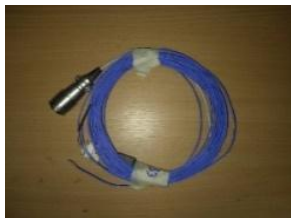
รูปที่ 6 Thermal gauge: Kyowa model Type K Thermocouple, Range of -270^{\circ}\text{C} to 1,290^{\circ}\text{C}
