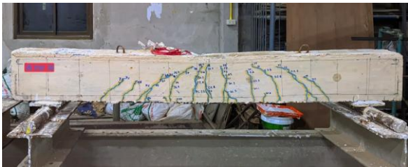
รูปที่ 24 ลักษณะการแตกร้าวและการวิบัติของคานตัวอย่าง B5-SF20-8D
