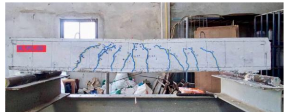
รูปที่ 20 ลักษณะการแตกร้าวและการวิบัติของคานตัวอย่าง B1-SF0-0D
