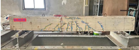
รูปที่ 23 ลักษณะการแตกร้าวและการวิบัติของคานตัวอย่าง B4-SF10-8D
