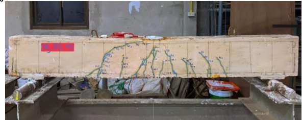
รูปที่ 21 ลักษณะการแตกร้าวและการวิบัติของคานตัวอย่าง B2-SF0-5D
