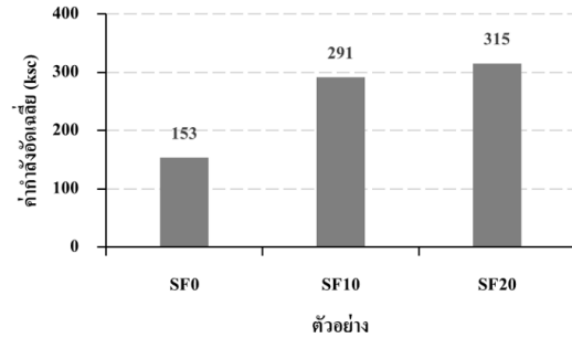
รูปที่ 7 กำลังรับแรงอัดของคอนกรีตในอัตราส่วนผสมซิลิกาฟุมที่แตกต่างกัน
