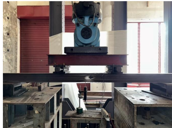
รูปที่ 3 Test setup สำหรับคานที่ไม่มีความเสียหาย
