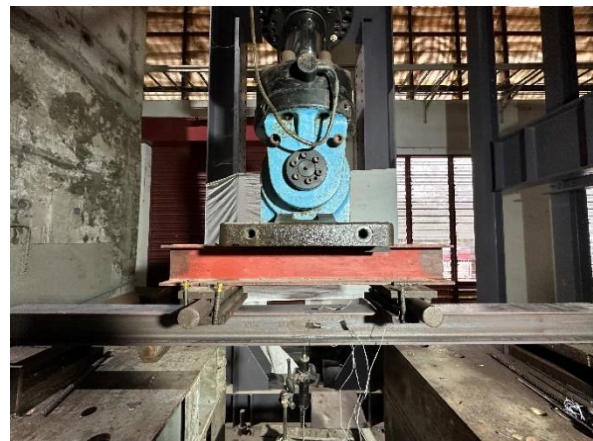
รูปที่ 4 Test setup คานที่มีการจำลองความเสียหาย
