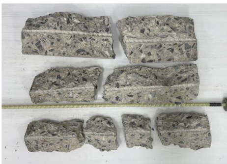
รูปที่ 18 แสดงลักษณะการวิบัติของคอนกรีตตัวอย่าง CY304G50
