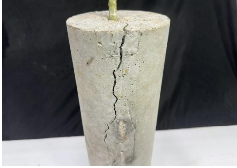
รูปที่ 15 แสดงลักษณะการวิบัติของคอนกรีตตัวอย่าง CY304G20 (GFRP ระยะฝัง 20 เซนติเมตร คอนกรีตกำลังอัดประลัย 304 ksc)
