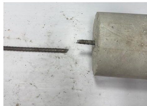
รูปที่ 21 แสดงลักษณะการวิบัติของคอนกรีตตัวอย่าง CY210S20 (เหล็ก ระยะฝัง 20 เซนติเมตร คอนกรีตกำลังอัดประลัย 210 ksc)
