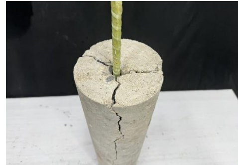
รูปที่ 12 แสดงลักษณะการวิบัติของคอนกรีตตัวอย่าง CY210G40 (GFRP ระยะฝัง 40 เซนติเมตร คอนกรีตกำลังอัดประลัย 210 ksc)
