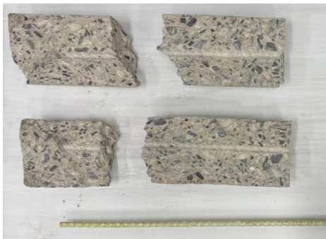
รูปที่ 17 แสดงลักษณะการวิบัติของคอนกรีตตัวอย่าง CY304G40 (GFRP ระยะฝัง 40 เซนติเมตร คอนกรีตกำลังอัดประลัย 304 ksc)
