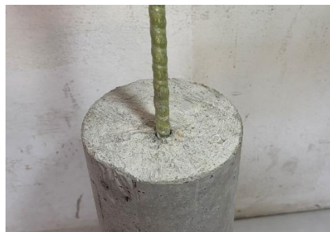
รูปที่ 14 แสดงลักษณะการวิบัติของคอนกรีตตัวอย่าง CY304G15 (GFRP ระยะฝัง 15 เซนติเมตร คอนกรีตกำลังอัดประลัย 304 ksc)
