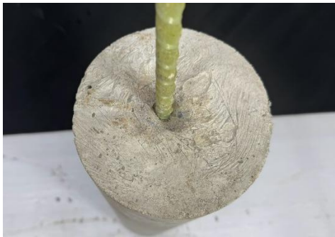
รูปที่ 9 แสดงลักษณะการวิบัติของคอนกรีตตัวอย่าง CY210G15 (GFRP ระยะฝัง 15 เซนติเมตร คอนกรีตกำลังอัดประลัย 210 ksc)
