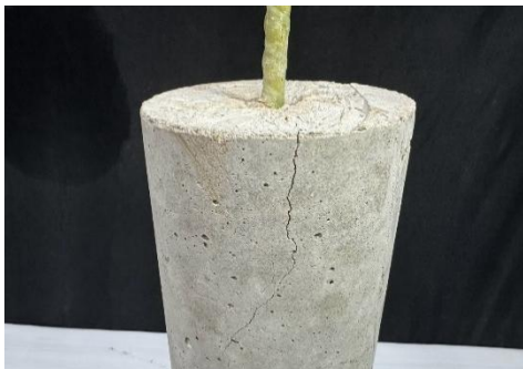
รูปที่ 10 แสดงลักษณะการวิบัติของคอนกรีตตัวอย่าง CY210G20 (GFRP ระยะฝัง 20 เซนติเมตร คอนกรีตกำลังอัดประลัย 210 ksc)
