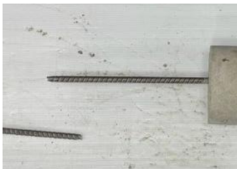
รูปที่ 24 แสดงลักษณะการวิบัติของคอนกรีตตัวอย่าง CY304S30 (เหล็ก ระยะฝัง 30 เซนติเมตร คอนกรีตกำลังอัดประลัย 304 ksc)
