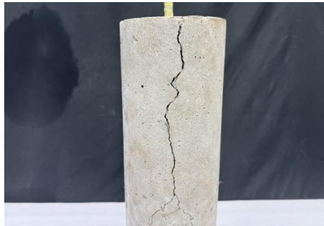
รูปที่ 16 แสดงลักษณะการวิบัติของคอนกรีตตัวอย่าง CY304G30 (GFRP ระยะฝัง 30 เซนติเมตร คอนกรีตกำลังอัดประลัย 304 ksc)
