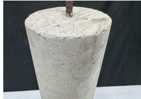
รูปที่ 19 แสดงลักษณะการวิบัติของคอนกรีตตัวอย่าง CY210S15 (เหล็ก ระยะฝัง 15 เซนติเมตร คอนกรีตกำลังอัดประลัย 210 ksc)
