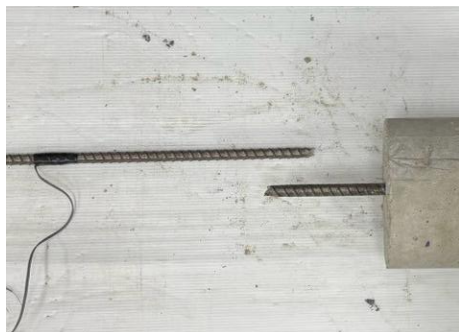
รูปที่ 23 แสดงลักษณะการวิบัติของคอนกรีตตัวอย่าง CY304S20 (เหล็ก ระยะฝัง 20 เซนติเมตร คอนกรีตกำลังอัดประลัย 304 ksc)
