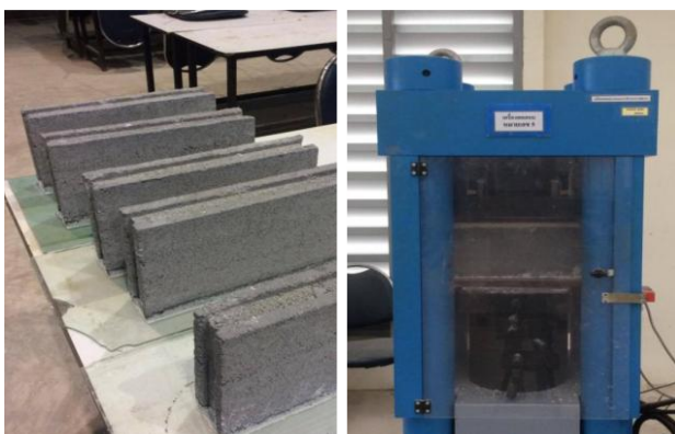
รูปที่ 3 อิฐซีเมนต์ และเครื่องทดสอบขนาด 500 ตัน ในห้องปฏิบัติการ
