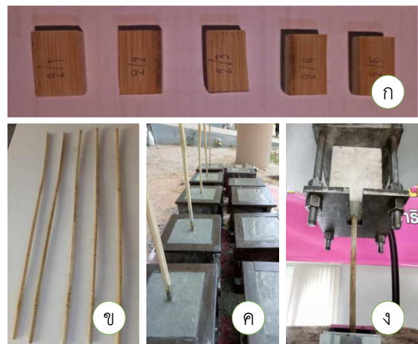
รูปที่ 1 ตัวอย่างที่ใช้ในการทดสอบคุณสมบัติของไม้ไผ่ป่า
