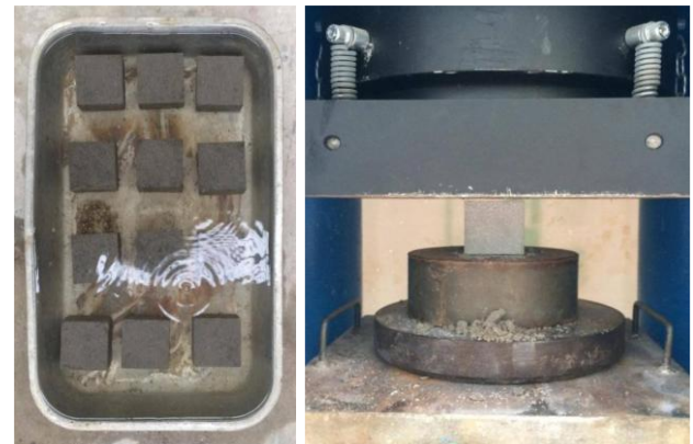
รูปที่ 5 การบ่มมอร์ตาร์และการทดสอบกำลังรับแรงอัดด้วยเครื่องทดสอบขนาด 500 ตัน
