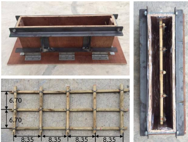
รูปที่ 2 ตะแกรงไม้ไผ่ปาสำหรับเสริมอิฐซีเมนต์พร้อมแบบหล่อ (ระยะในรูปมีหน่วยเซนติเมตร)
