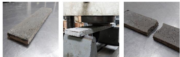
รูปที่ 8 การทดสอบโมดูลัสแตกร้าวของแผ่นซีเมนต์เส้นใย
