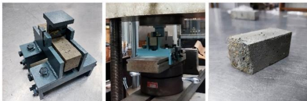
รูปที่ 5 การทดสอบกำลังต้านแรงดัดของแท่งมอร์ตาร์
