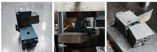
รูปที่ 6 การทดสอบกำลังต้านแรงอัดของแท่งมอร์ตาร์
