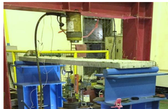
รูปที่ 1 รูปแบบการทดสอบการให้น้ำหนักบรรทุกและการติดตั้งอุปกรณ์ตรวจวัด
