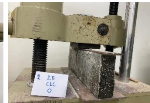
(ข) ตัวอย่างหลังรับแรงจนถึงวิบัติ
