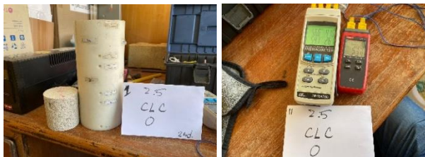
(ก) การทดสอบหาค่าการนำความร้อน (ข) ค่าการนำความร้อนที่ได้จากการทดสอบ
