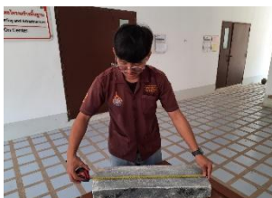
(ก) การวัดขนาดตัวอย่างทดสอบ (ข) ตัวอย่างทดสอบขนาด 200 x 600 x 75 mm
