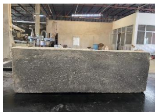
(ก) การวัดขนาดตัวอย่างทดสอบ (ข) ตัวอย่างทดสอบขนาด 200 x 600 x 75 mm
